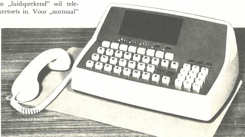
Schakelpaneel voor een moderne huistelefoon-centrale, de CEL-citomat.
